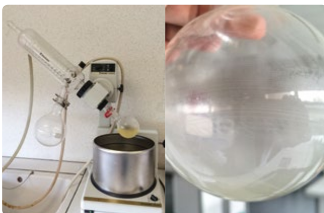
FIG. 8 Avdunstning av lösningsmedlet med en rotationsavdunsnare (vänster) · Pulver på kolvens sidor efter att lösningsmedlet har avdunstat
