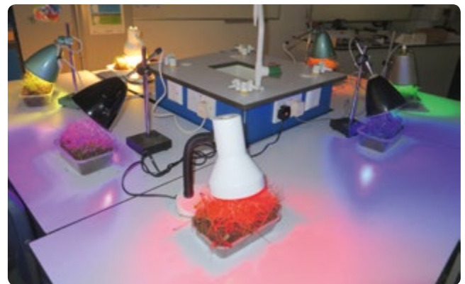
FIG. 9 Brickor med gräs belystes med ljus av olika färger i sex dagar innan gräset skördades för bestämning av färskvikten som ett mått på tillväxthastigheten.
