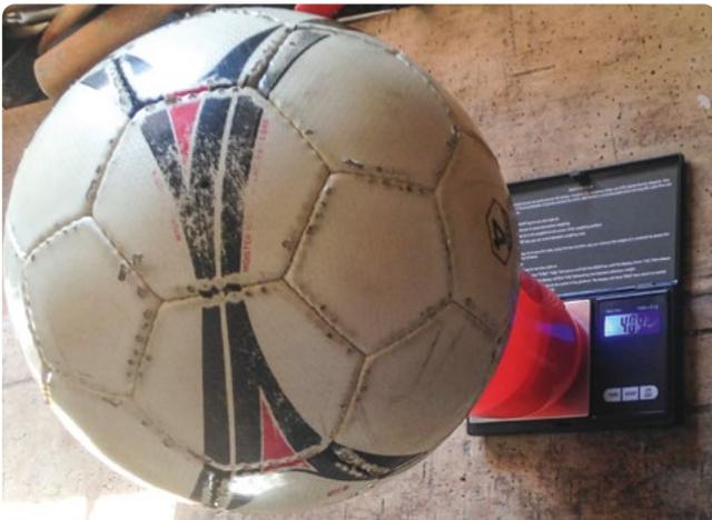
ABB. 3 Ball auf der Waage · Messung der Masse des leeren Balls
