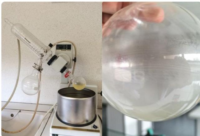
ABB. 8 Verdampfung des Lösungsmittels im Rotationsverdampfer (links) · Pulver am Rand des Kolbens nach der Verdampfung des Lösungsmittels
