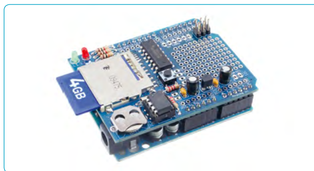
© 7: Data Logger Shield saldato su Arduino [4]
