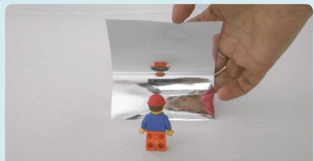
Verticaal gebogen spiegel: boven- en onderkant zijn omgedraaid
